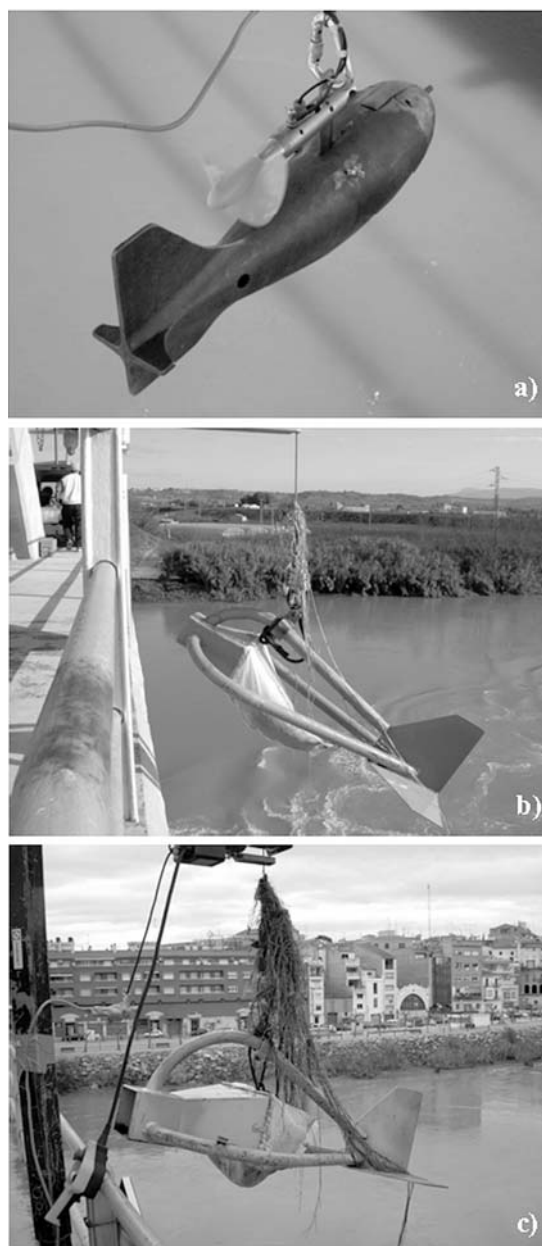
Figura 2 (a). Muestreador de integración en profundidad US DH74 para sedimentos en suspensión, con molinete OTT C-31 para la medición de la velocidad del flujo, (b) Muestreador Helley-Smith de 29 kg y boca de 76 mm y (c) muestreador Helley-Smith de 76 kg y boca de 152 mm para la carga de fondo.
